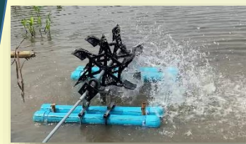
เปิดเครื่องตีน้ำ หลังฝนตก คลุกเคล้าน้ำฝนกับน้ำในบ่อเลี้ยง ให้เป็นเนื้อเดียวกัน
